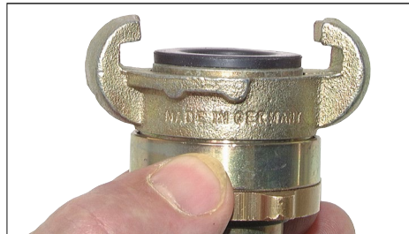
Vorgeschraubte Dichtung - Verbindung ist dicht.
